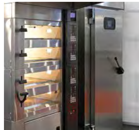
Contrôle de température sur four industriel.
