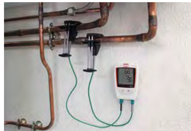
KTT 220 équipé de deux sondes thermocouple à pince pour le contrôle du réseau d'eau chaude sanitaire (ECS), sur platine de fixation murale.
