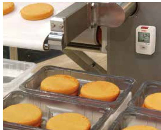
Boîtier IP65, conforme à la norme imposée dans l'industrie agroalimentaire
